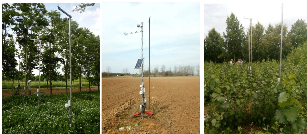
Obr. 3.1-2. Umístění stožárů v pokusných porostech Michovky: ALS1 (stožáry P1-4, plodina hrách), Pole (stožár P5 a berlička pro dravé ptáky) a RRD (stožáry P6-9, výmladková plantáž na fotce je 3 měsíce po sklizni).
