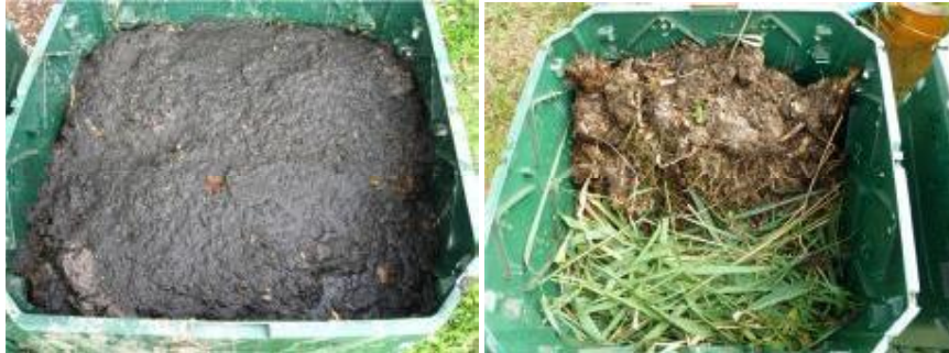
Obr. 5 Plnění plastových kompostérů o objemu 600 litrů kaly z mechanického předčištění a biomasou z povrchu kořenových polí
