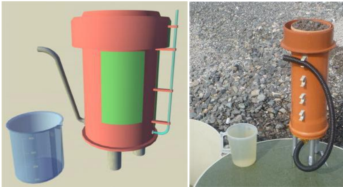
Obr. 1 Schéma užitého vzoru a pohled na měření hydraulické vodivosti v terénu
