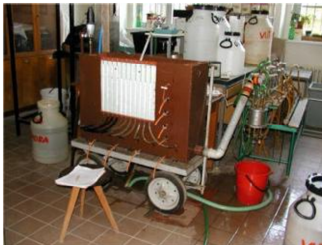
Obr.7 Testovací zařízení na sledování průběhu kolmatace při horizontálním proudění
