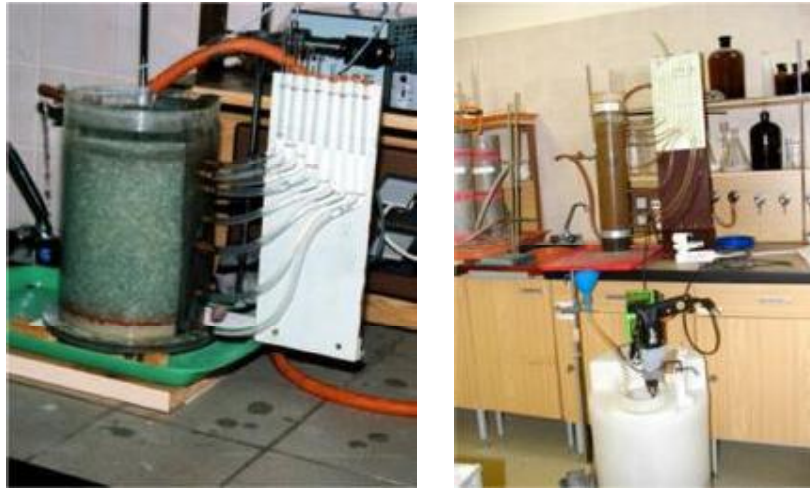
Obr.6 Uspořádání testovacích zařízení na sledování průběhu kolmatace
