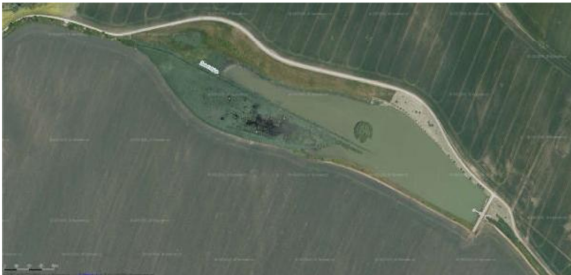
Obr. 3 Letecký snímek MVN Želeč v roce 2009 s rozsáhlou mokřadní zónou tvořenou porostem rákosu obecného a bočními nárazníkovými zónami pro eliminaci vlivu erozních smyčů (zdroj: www.mapy.cz )
